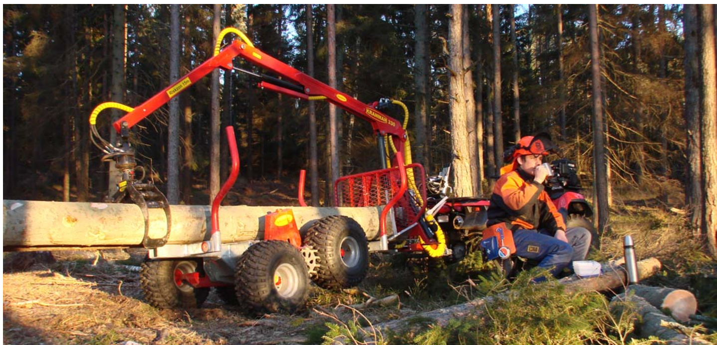
Bilden visar Kran: Kranman 330, Vagn: T1800 Flexodrive 4WD, Hydraulvinsch HV500 och ramstyrning
