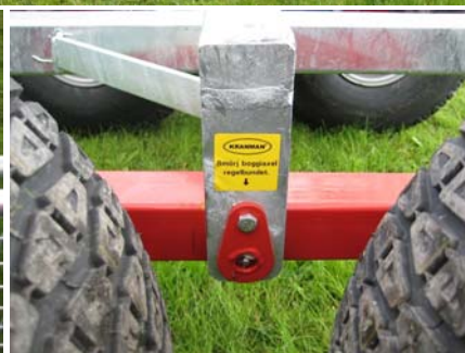
Boggieaxelns smörjnippel sitter väl skyddad.
